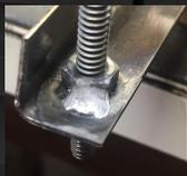
Testamos pela primeira vez as hastes de alumínio de baixa fusão para solda de inox e ferro. Sucesso, solda perfeita com o maçarico.
